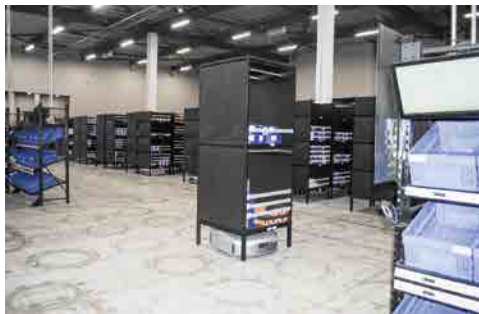
人に代わってロボットが倉庫内を棚を持って動きまわるピッキングシステムは、入荷・出荷・棚卸作業の生産性を飛躍的に向上させる。
