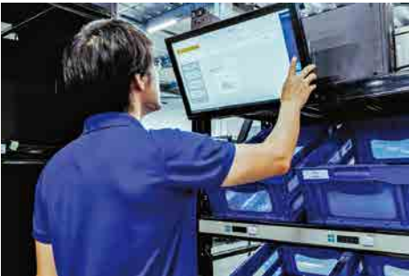
ワーキングステーションに設置されたタッチパネルディスプレイの指示に従って作業するだけなので、ヒューマンエラーはほぼ皆無になる。
