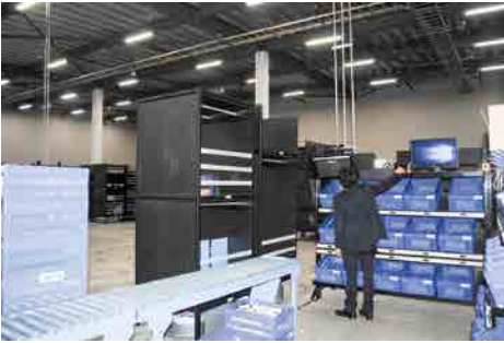
ロボットが作業者の待機しているワーキングステーションまで棚を搬送するため、生産性向上に加え、倉庫要員も大幅削減が可能だ。
